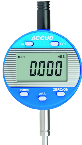
Digital precision indicator 0,001mm
